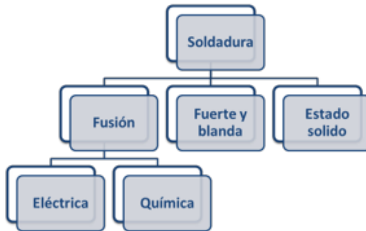
Fig. 1 Clasificación de los procesos de unión por soldadura
